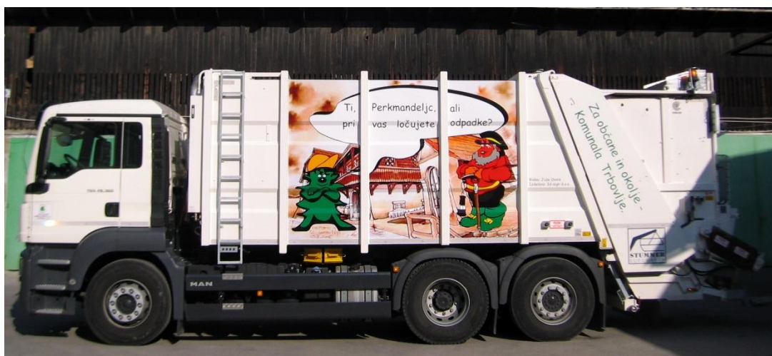
Slika št. 1: Kombinirano smetarsko-pralno vozilo za čiščenje zbiralnikov za odpadke
