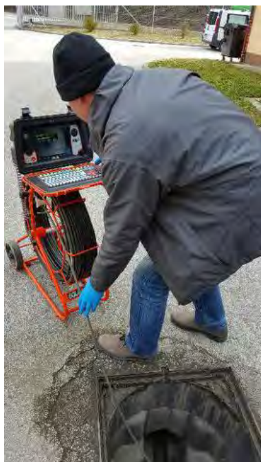
Operater s potisno kamero za pregled cevovodov
